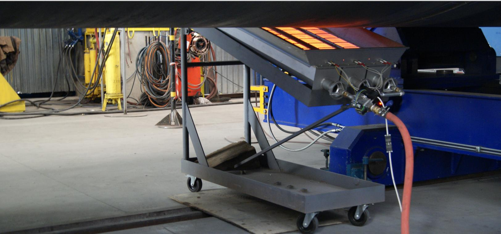
Излучатель для разогрева материала перед сваркой
